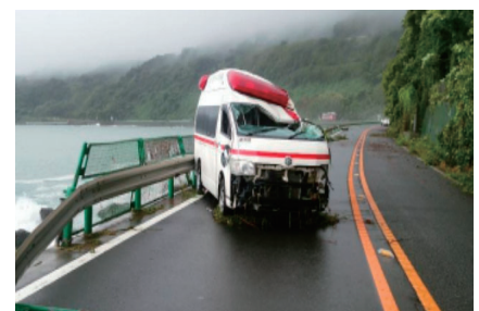
写真-3 高波により被災した緊急車両
