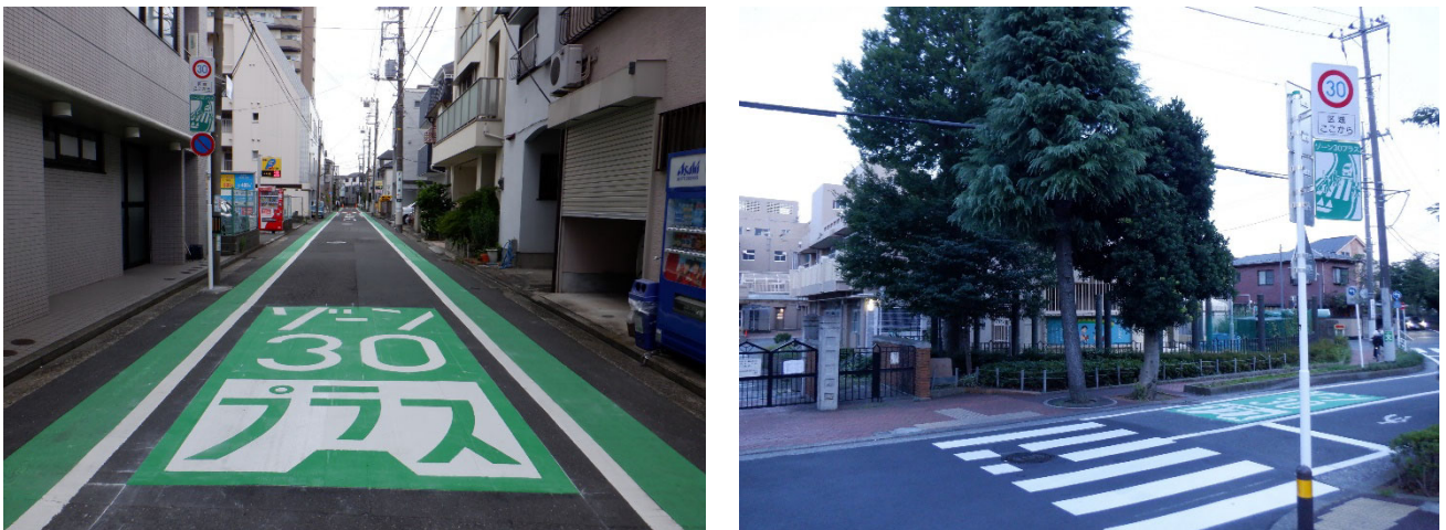
図-13 ゾーン30プラスの看板・路面標示
