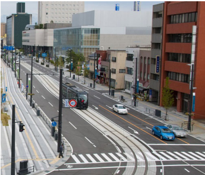
図-3 軌道線形をシフトさせ右折レーンを確保（右：富山ライトレール、左：市内電車環状線化）
