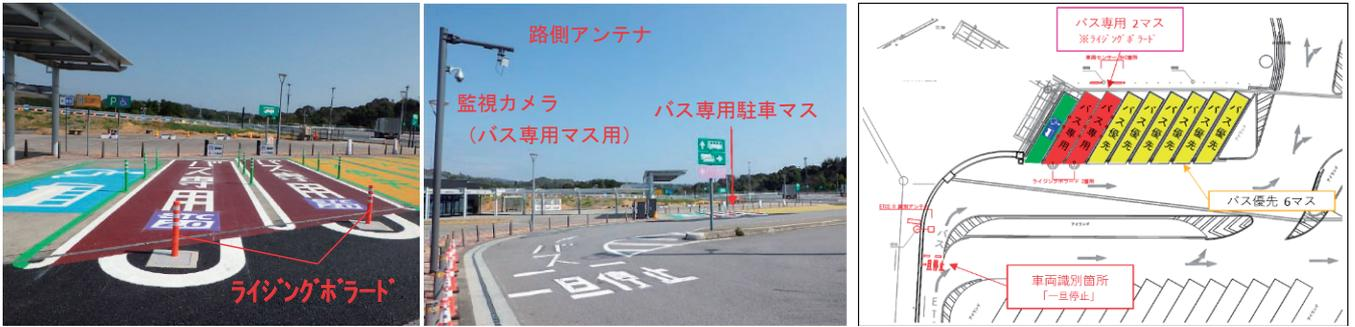
図-8 ライジングボラードを活用したバス専用駐車マス（浜松 SA（東京方面））
