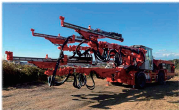
写真－２ フルオートコンピュータドリルジャンボ
