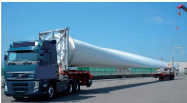
写真1 江差港で風力発電施設のブレードを積載するポルトレーラ
