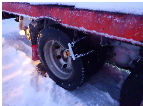
写真12 緊急脱出用具の装着状況
