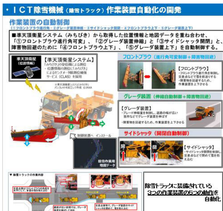
図 13 ICT 除雪機械（除雪トラック）作業装置自動化の開発
