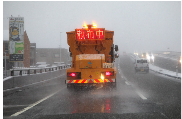
写真4 凍結防止剤散布車による凍結防止剤散布状況
