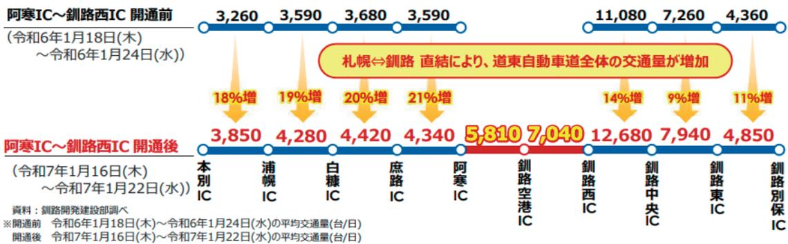
図⑧：道東自動車道の区間別交通量の変化
