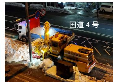
写真5 ロータリー除雪車でダンプトラックに積み込み（青森市）
