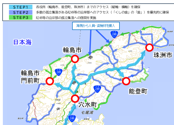
図-1 能登半島地震における道路啓開
