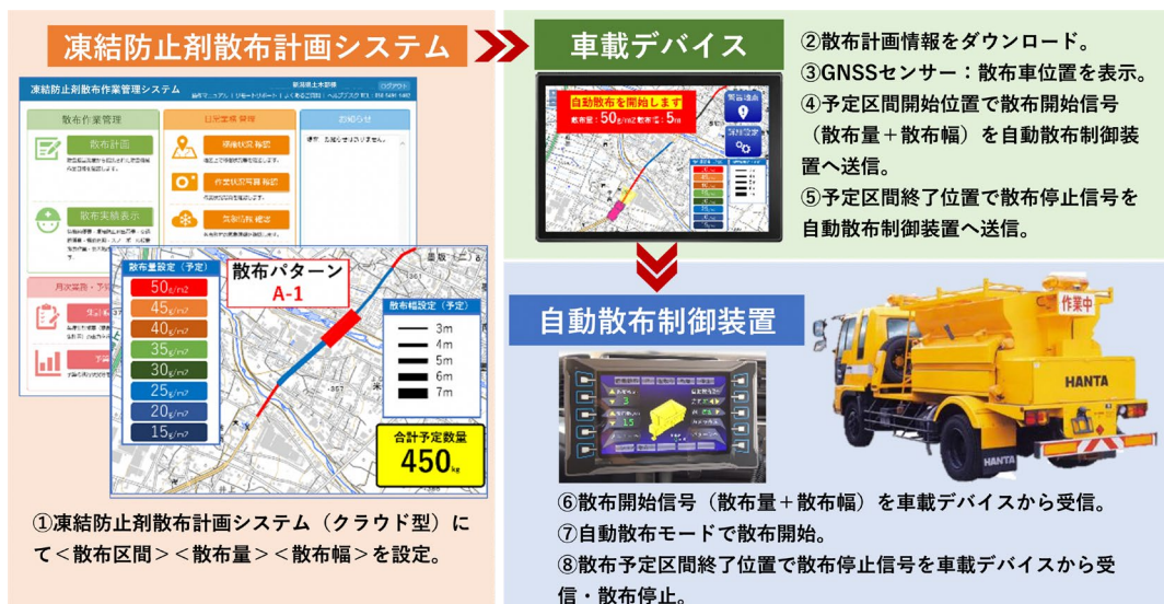
図3 凍結防止剤自動散布システムの構成
