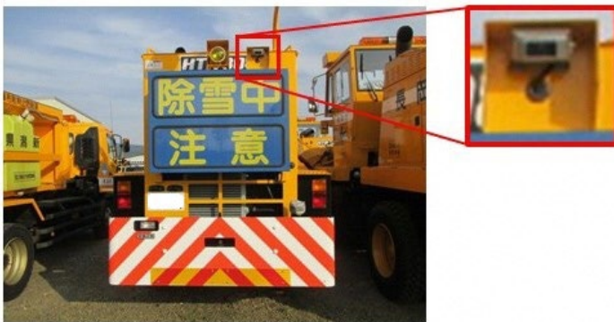
写真3 バックカメラの設置状況
